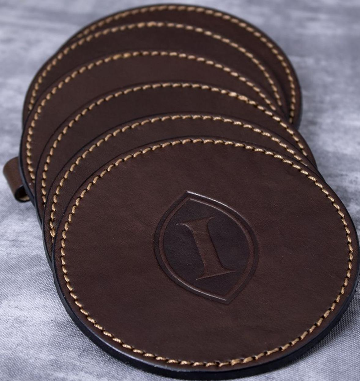
Grabado sobre cuero mediante el uso de un cuño metálico, presión y calor.
